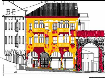
VERIFICA DELLA CLASSIFICAZIONE VISIBILE DEL DEGRADO SUPERFICIALE E DELLE DISCONTINUITA' TERMICHE MEDIANTE L'UTILIZZO DELLE INDAGINI TERMOGRAFICHE
