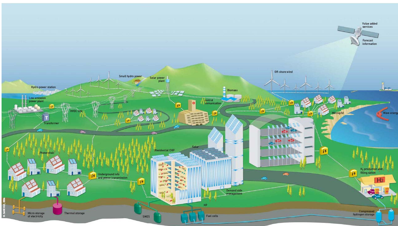
Fig. 2.1 - La visione europea per la trasformazione del sistema energetico: la smart grids è la rete connessa di una serie di distretti energetici integrati ( power parks ) autosufficienti dal punto di vista della generazione di energia localmente consumata
